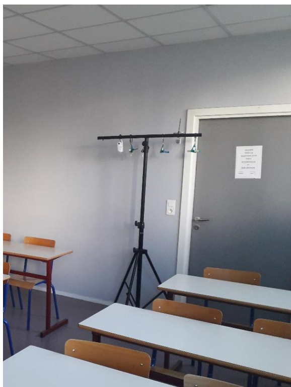
Figure 7 : Mise en place des tubes passifs dans une salle de classe et à l'extérieur
