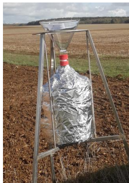
Figure 8 : Jauge pour le prélèvement des retombées atmosphériques totales
