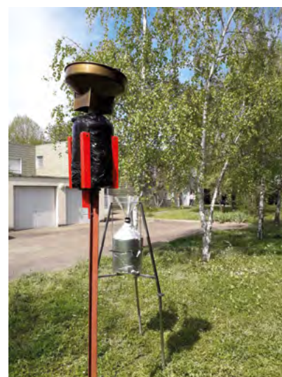
Jauges de mesure des retombées atmosphériques totales
