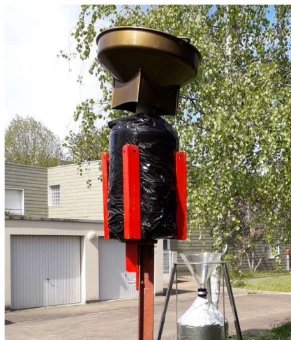
Figure 1 : Jauge pour le prélèvement des poussières dans les retombées atmosphériques totales
