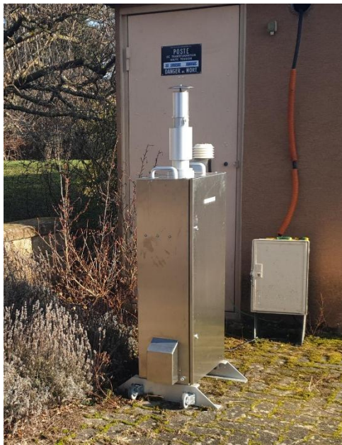
Figure 1 : Appareil pour le prélèvement des particules PM 10 pour la mesure des métaux lourds
