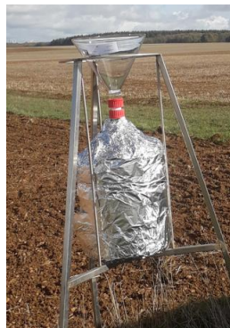
Figure 9 : Jauge pour le prélèvement des retombées atmosphériques totales
