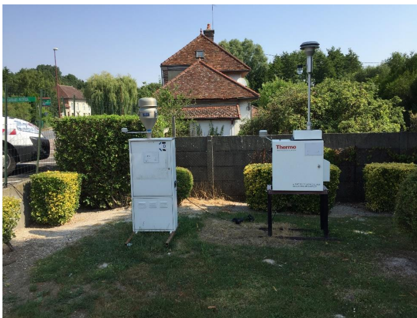
Figure 6 : Photo des préleveurs (à gauche pour le glyphosate et ses métabolites, à droite pour les autres substances)
