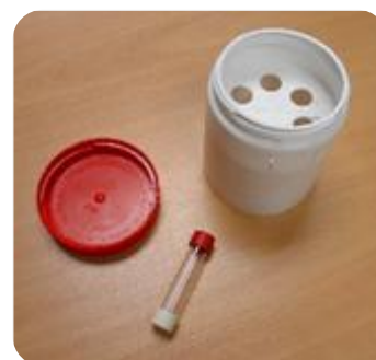
Figure 5 : Tube passif pour le prélèvement du NO 2 (et des BTEX).
