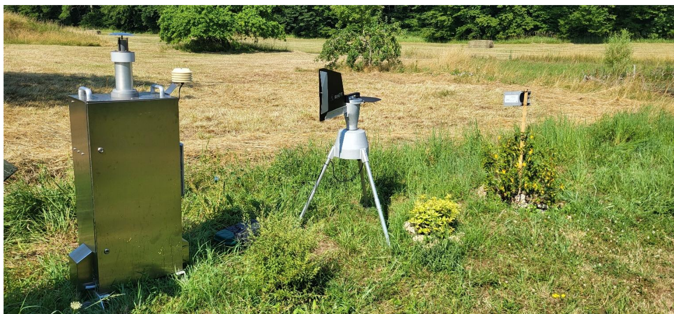
Figure 4 : de gauche à droite, préleveur moyen débit, capteur pollen et capteur passif avec bande adhésive
